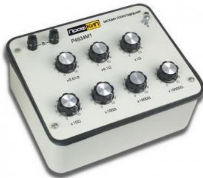
Рисунок 1 – Общий вид магазина сопротивлений
