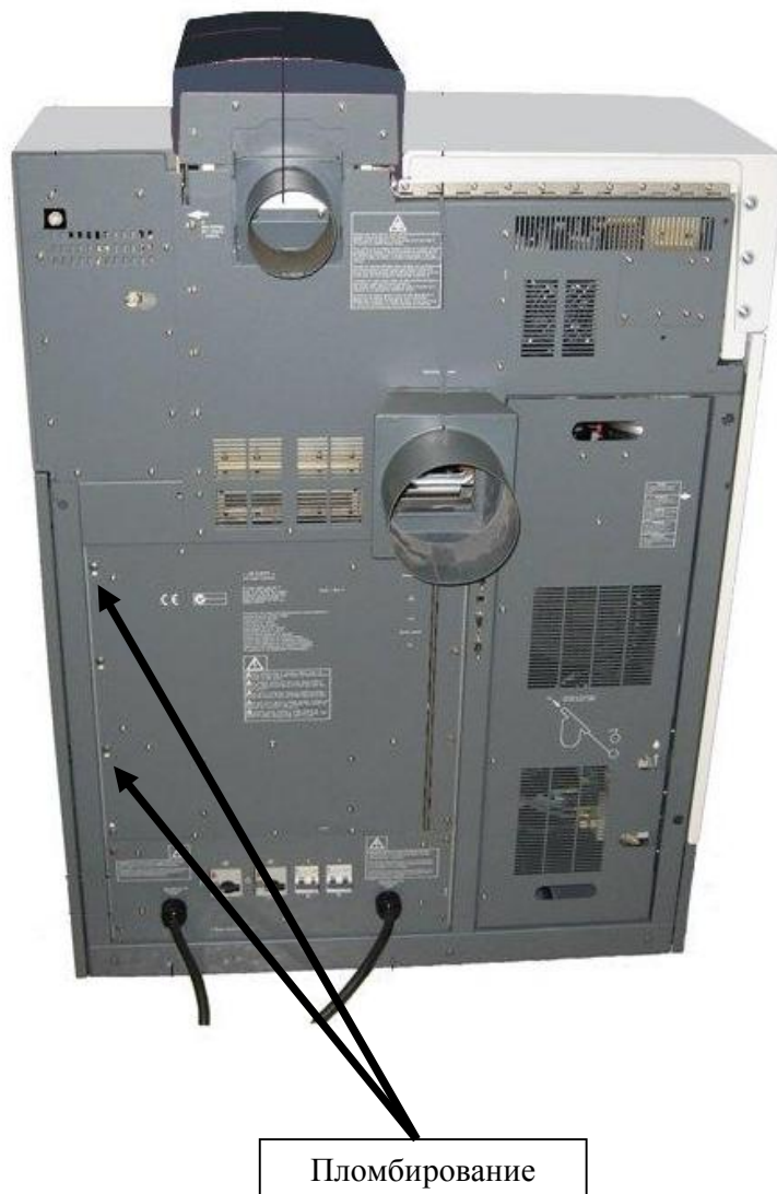
Рисунок 2 – Масс-спектрометр с индуктивно связанной плазмой модели Aurora M90 с обозначением мест пломбировки (вид сзади).
