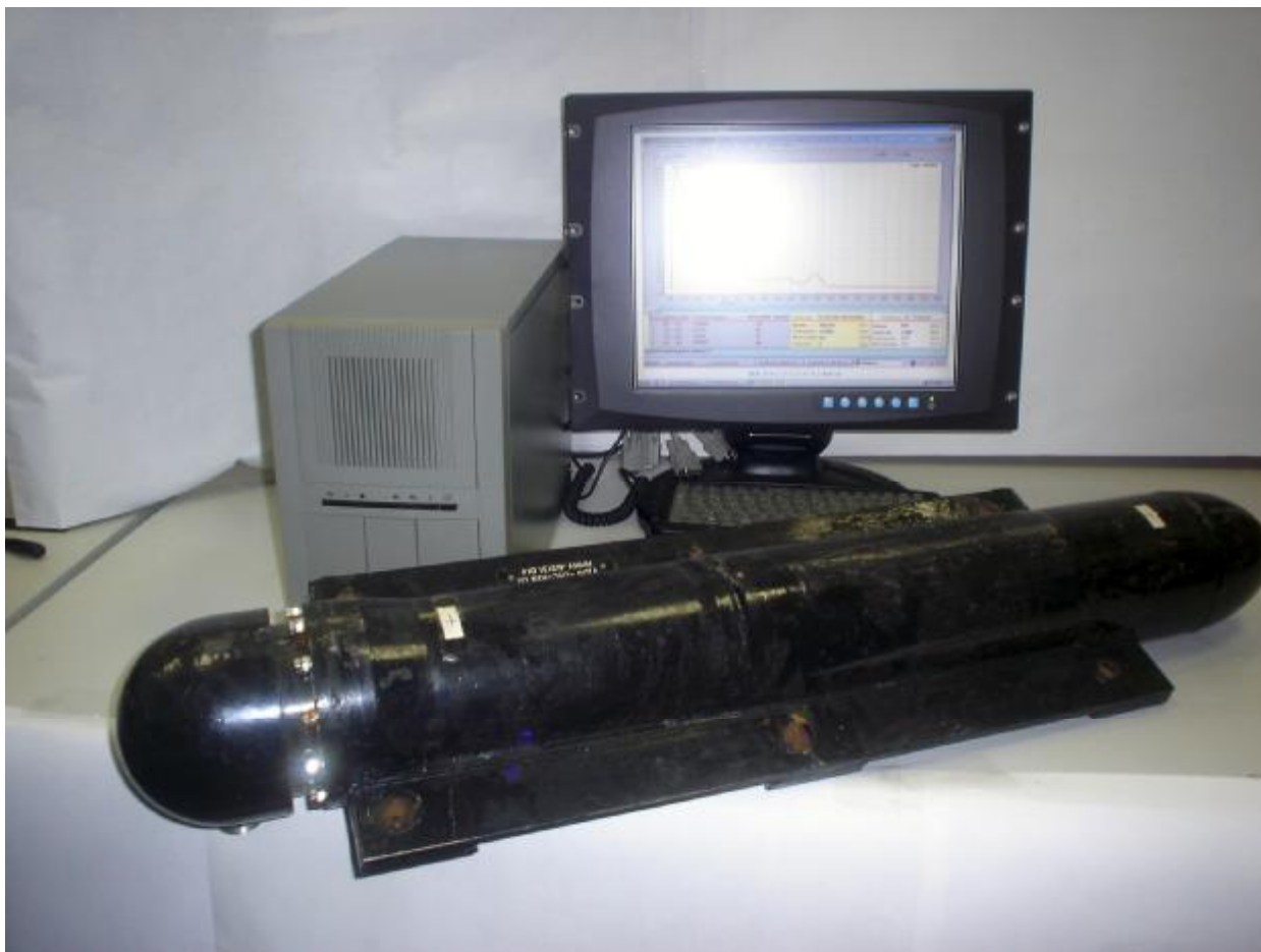
Рис. 1. Фотография общего вида спектрометра – радиометра МКГ-01Гр-1
