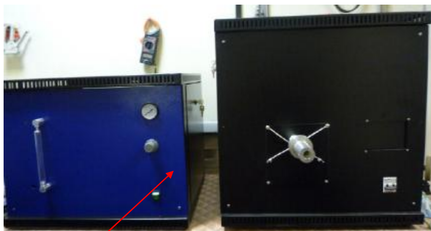
Рисунок 1 – Внешний вид анализаторов углерода и серы МЕТЭК-200 Место нанесения поверительного клейма (или знака поверки в виде наклейки)
