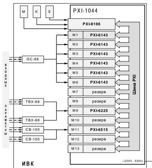
Рисунок 2 - Функциональная схема ИВК
