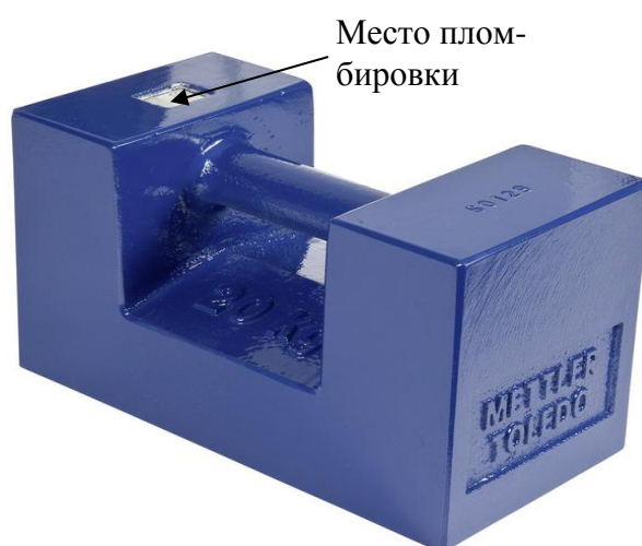
Рисунок 5 – Общий вид гирь в форме параллелепипеда с номинальной массой 5 кг до 50 кг
