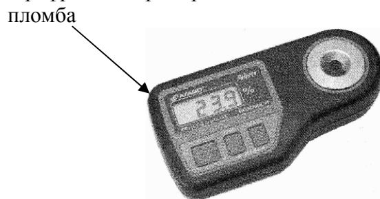
Рис. 1. Рефрактометр автоматический серии PALETTE, модель PR-201alpha
