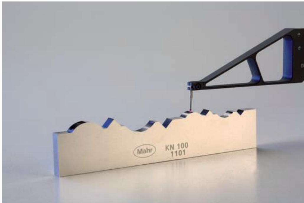
Рисунок 2 – Общий вид меры для поверки приборов для измерений контура поверхности KN 100
