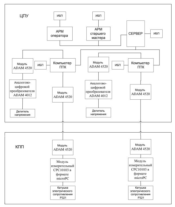
ЦПУ— центральный пульт управления, КПП — кремниево-преобразовательная подстанция, ИБП — источник бесперебойного питания, ПТК — програмно-технический комплекс
