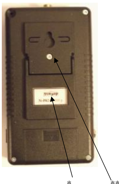
Рисунок 2 – УФ - диапазона ТЕНЗОР-31, задняя панель, *-место маркировки, **-место пломбировки
