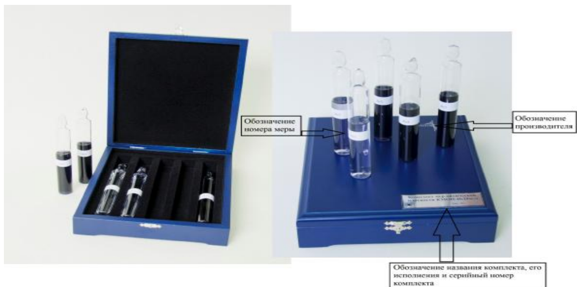
Рис. 2- Комплект мер оптической плотности КМОП-Н исполнение 2.
