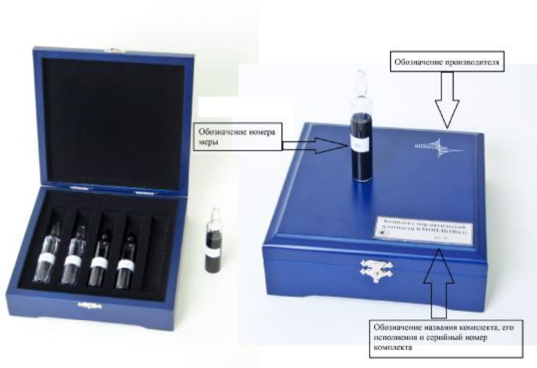
Рис. 1- Комплект мер оптической плотности КМОП-Н исполнение 1.
