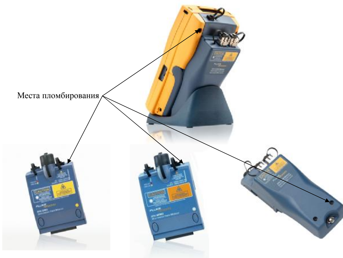
Рисунок 3 - Места пломбирования от несанкционированного доступа
