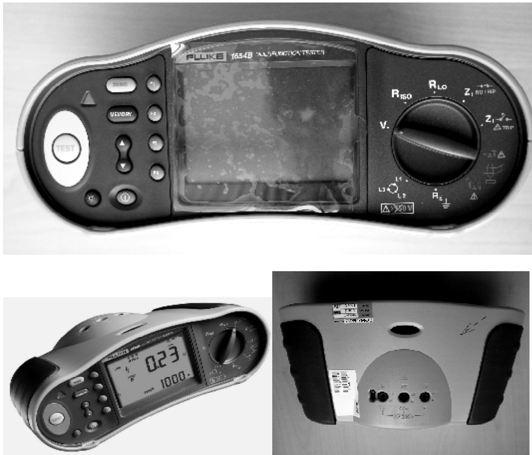
Рисунок 1 - Внешний вид тестеров электрических установок Fluke 1654B в разных ракурсах и при разных масштабах. Стрелкой показано место нанесения знака утверждения типа на верхнюю поверхность корпуса.
