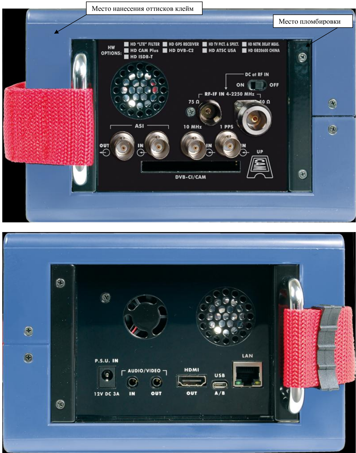
Рисунок 2 Схема пломбировки от несанкционированного доступа и нанесения отпечатков клейм
