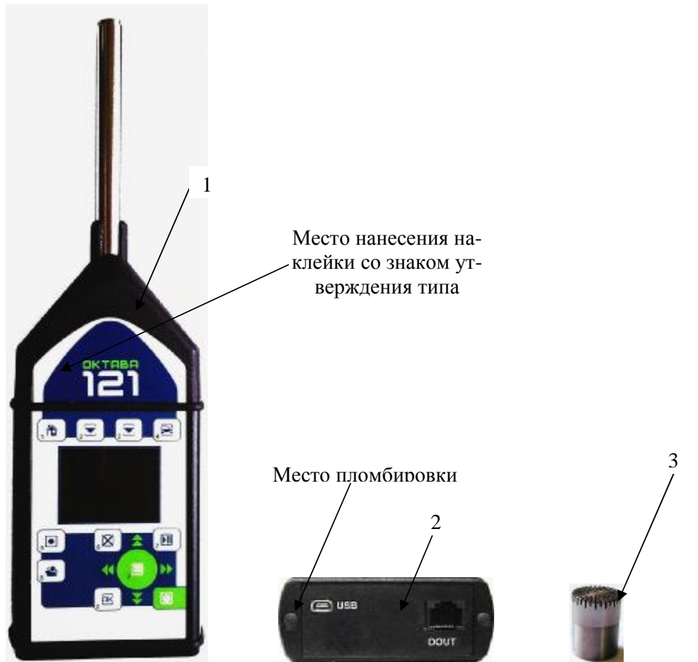
1 – Лицевая панель шумомера; 2 – шумомер - вид снизу; 3 – микрофонный капсюль
