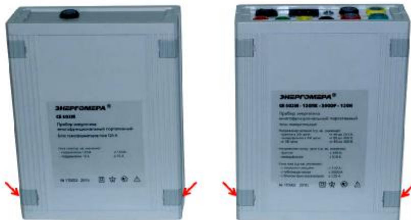
Рисунок 2 – Места пломбирования на нижних крышках блока трансформаторов тока (слева) и блока измерительного (справа) после поверки
