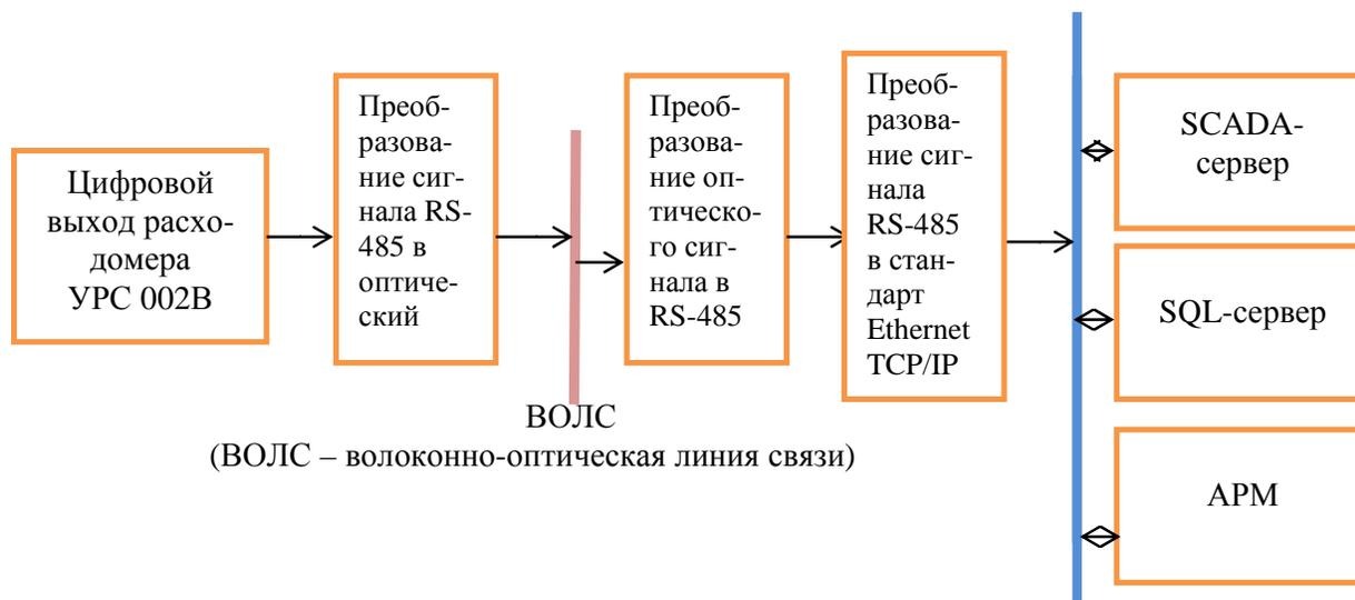
Рисунок 1 - Общая структурная схема передачи сигнала подсистемы АСДКУ
