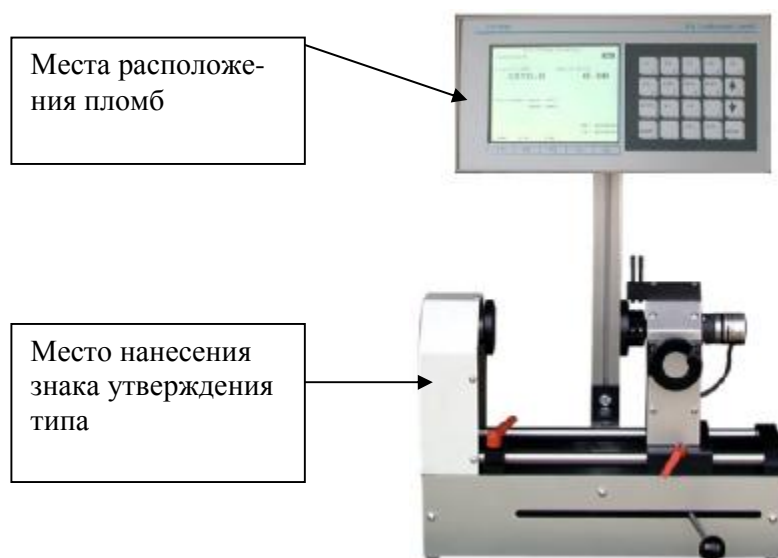
Рис. 2 – Места расположения пломб и место нанесения знака утверждения типа.
