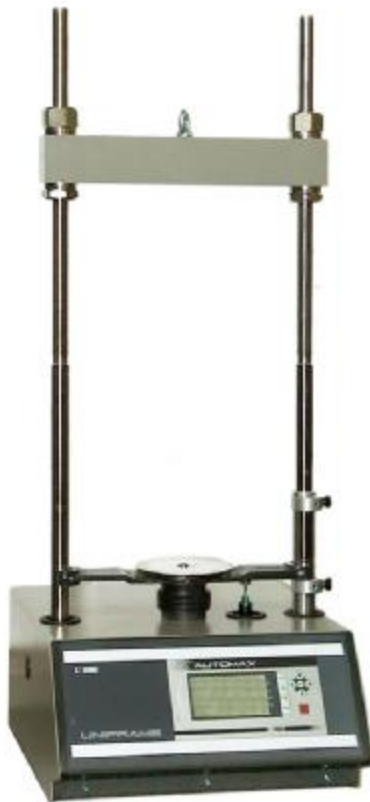
Рис.1. Пресс испытательный UNIFRAME 70-T0108/E
