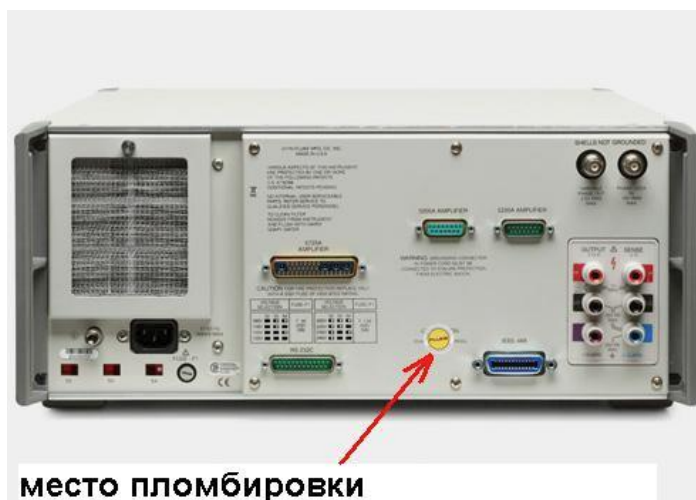
Рисунок 3 – Схема пломбировки от несанкционированного доступа.
