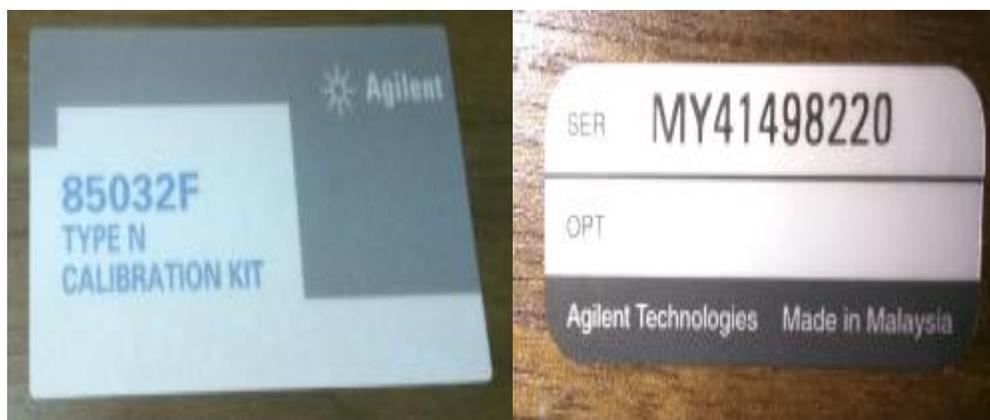
Рисунок 2 - Места для размещения наклеек типа средства измерений, заводского номера
