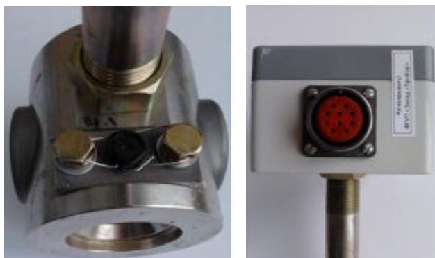
Рисунок 2 – Места пломбирования датчиков
