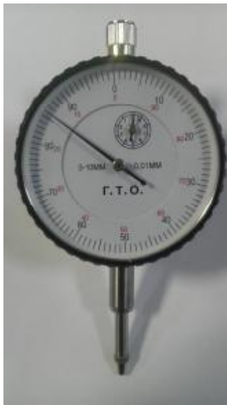
Рисунок 1 – Общий вид индикаторов часового типа с ценой деления 0,01 мм.
