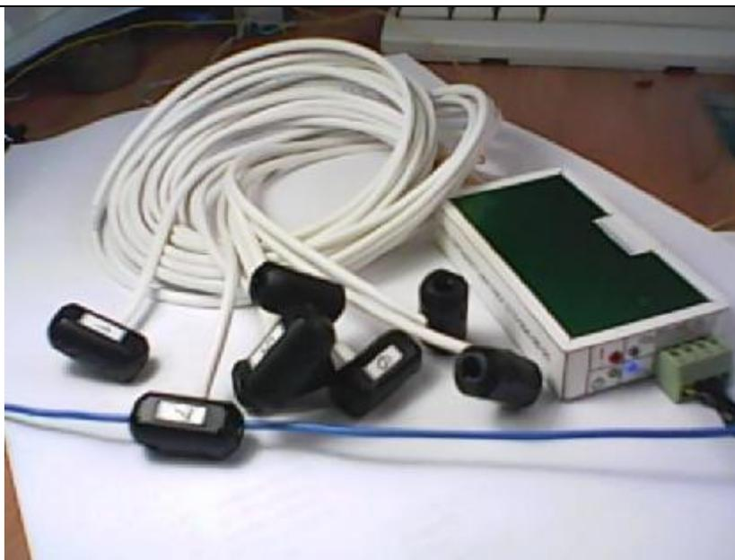
Рисунок 1 – Функциональный модуль БТ05-001-08 с датчиками напряжения.
