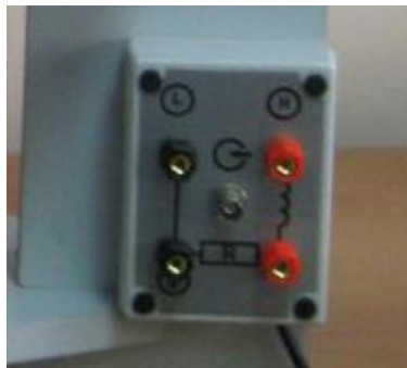
Рисунок 2 – Панель разъемов ● – место пломбирования от несанкционированного доступа.
