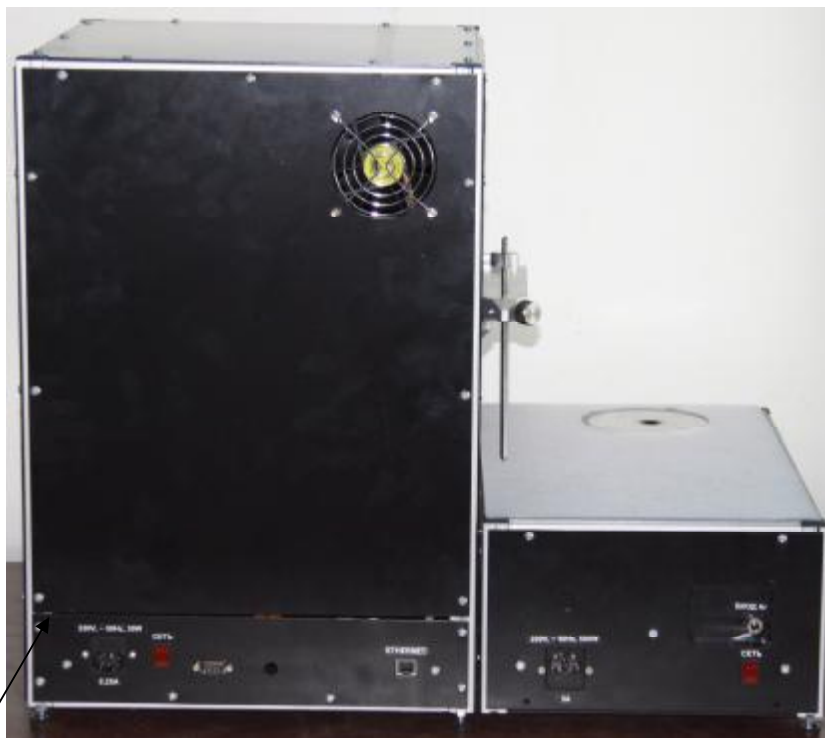
Рисунок 2 – Спектрометр атомно-эмиссионный фотоэлектрический многоканальный ЭМАС-200ССД, задняя панель, *-место пломбировки
