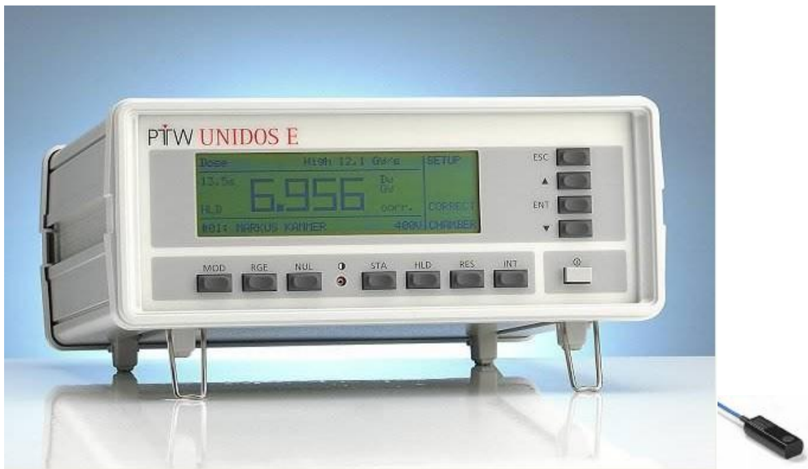
Рис. 1 Внешний вид дозиметра PTW-UNIDOS E и ионизационной камеры TN23342
