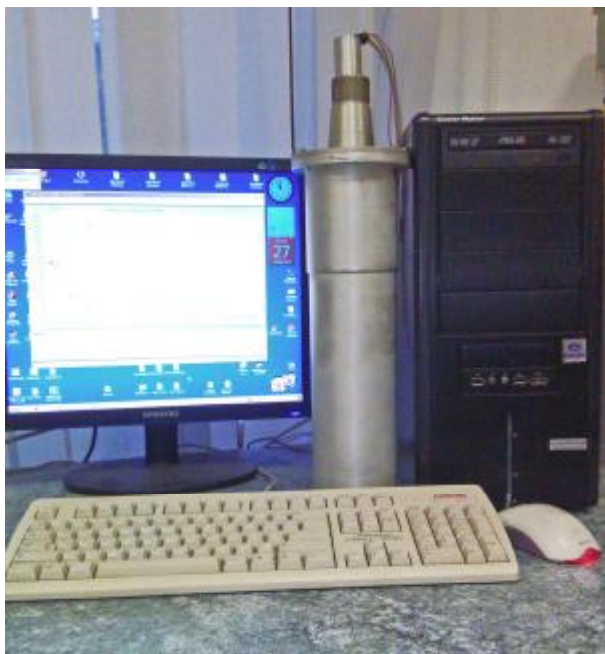
Рис. 1. Фотография общего вида гамма - спектрометра СЕГ-02Гр
