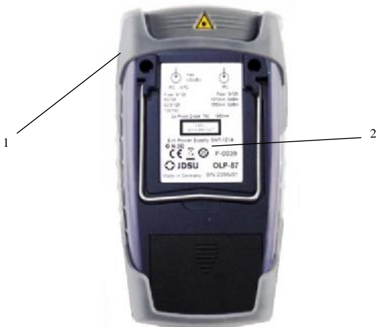
Рисунок 2 - Схема пломбирования и маркировки ваттметра – вид сзади 1 - место установки пломбы; 2 - место нанесения маркировки
