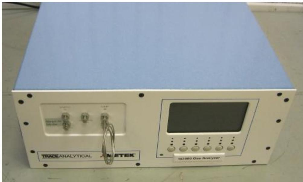
Рис. 1 – Внешний вид анализатора ta3000R SP
