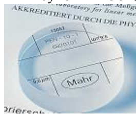
Рисунок 2 – Общий вид и форма профиля меры PEN 10-1
