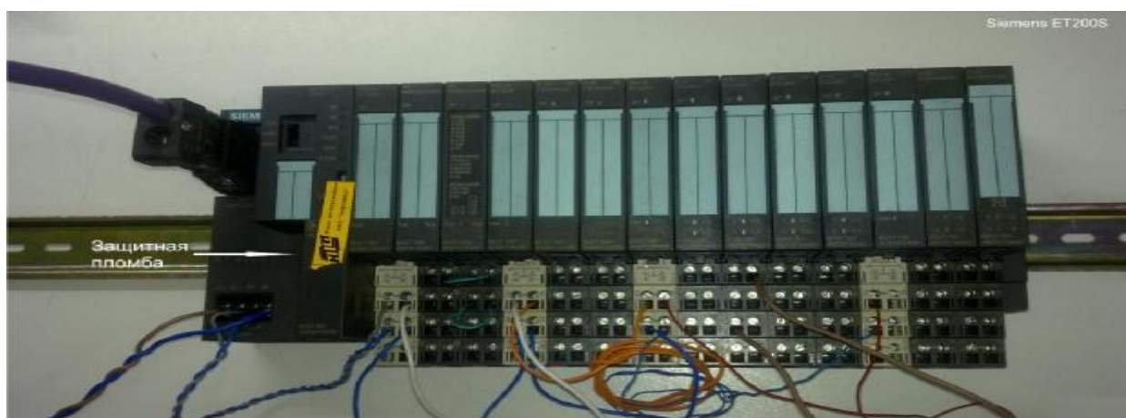
Рисунок 3 - Схема пломбирования контроллера «Siemens»
