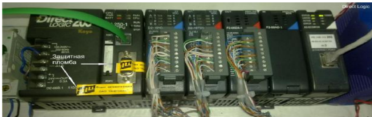
Рисунок 2 - Схема пломбирования контроллера «Direct Logic»
