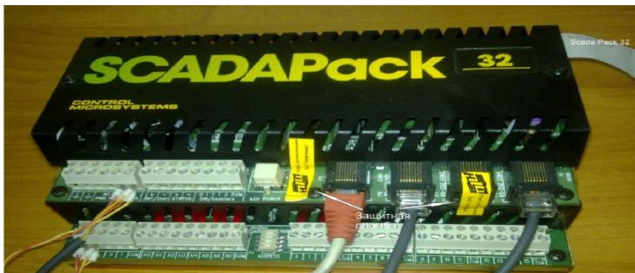
Рисунок 4 - Схема пломбирования контроллера «SCADAPack32»
