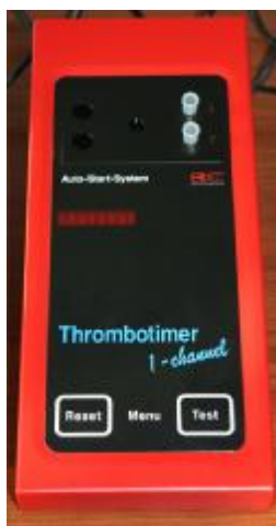
Рисунок 2 – Общий вид Прибора для определения времени свертываемости крови Thrombotimer 1
