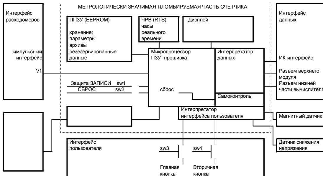
Рисунок 2. Функциональная блок-схема вычислителя
