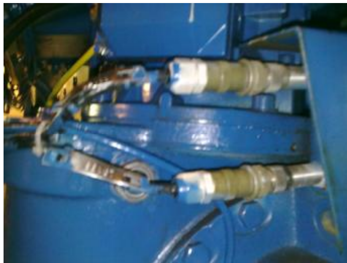
Рисунок 1. Общий вид датчика вращения индуктивного IFR 18.26.31/K713
