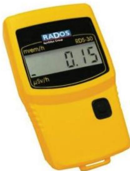
Рис. 1. Внешний вид дозиметра RDS-30
