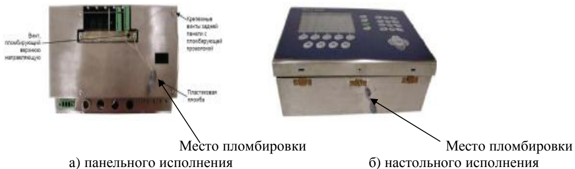
Рисунок 3 - Место пломбировки терминалов панельного и настольного исполнений
