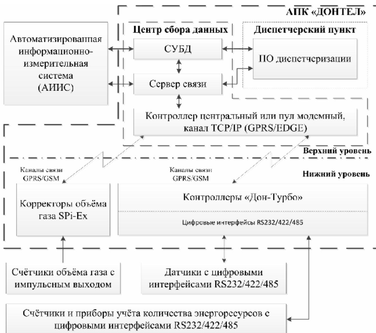
Рисунок 1 – Блок – схема комплексов
