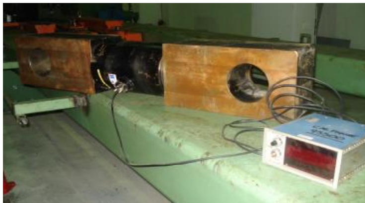
Рисунок 1. Общий вид динамометра электронного растяжения АЖТ 500Та
