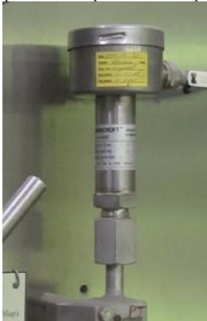
Рисунок. 1. Преобразователь давления измерительный модели KXD 42050.
