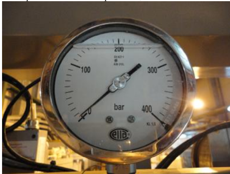
Рис. 1. Общий вид манометра показывающего BNI.
