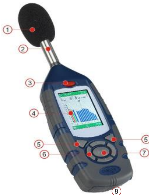
1 – Противоветровая защита, 2 – Встроенный предусилитель, 3 – Кнопка ВКЛ./ВЫКЛ., 4 – Дисплей, 5 – Программные кнопки, 6 – Кнопки курсора навигации, 7 – Кнопка Запуск/Остановка (Run/Stop), 8 – Разъемы для подключения внешних устройств
