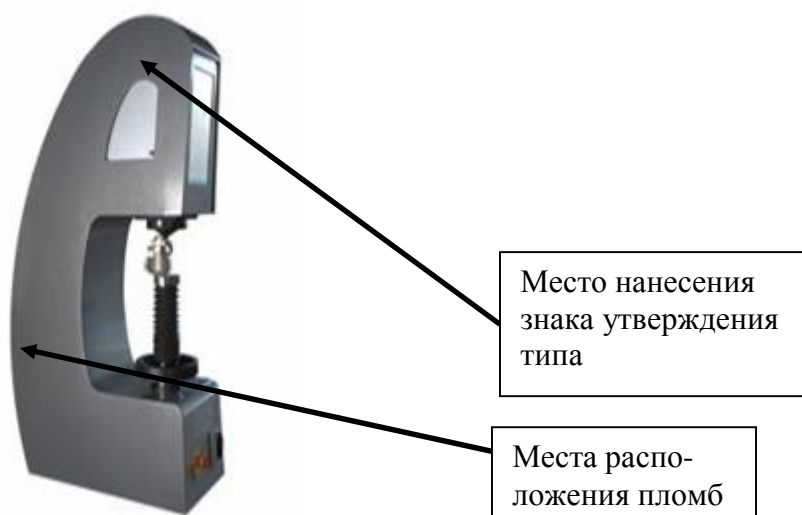
Рисунок 2 – Места расположения пломб и место нанесения знака утверждения типа.
