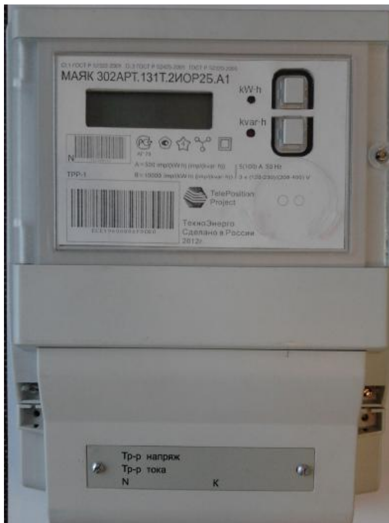
Рисунок 1 – Внешний вид счетчика с закрытой клеммной крышкой
