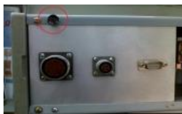
Рисунок 2 - Установка пломбы на регистрирующем блоке при использовании комплекса в составе стенда.
