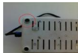
Рисунок 3 - Установка пломбы на регистрирующем блоке при автономном использовании комплекса
