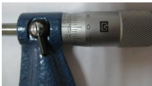
Рисунок 12 – Общий вид отсчета показаний по шкалам стебля и барабана с нониусом
