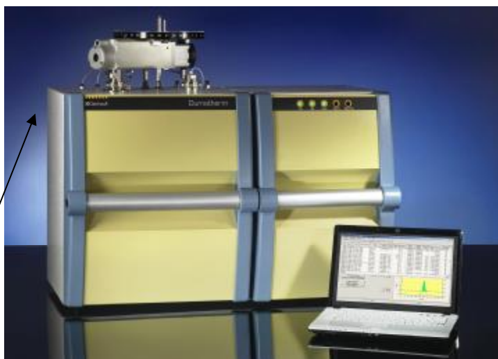
Рисунок 1 – Внешний вид анализатора азота/белка Dumatherm Место нанесения знака поверки
