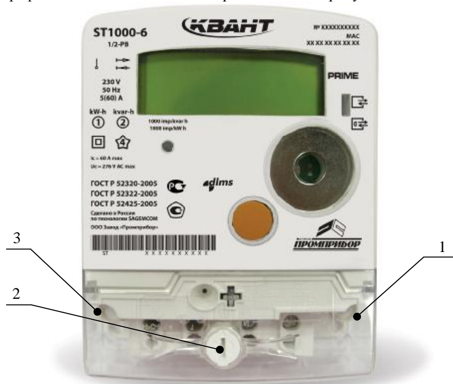
Рисунок 1 – Фотография общего вида счетчиков 1 – Пломба ОТК завода-изготовителя (под крышкой клеммной колодки); 2 – Пломба энергоснабжающей организации; 3 – Место размещения пломбы поверяющей организации (под крышкой клеммной колодки).
