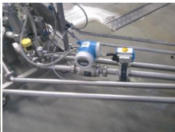
Фото 2. Расходомер Promag и дисковый затвор
