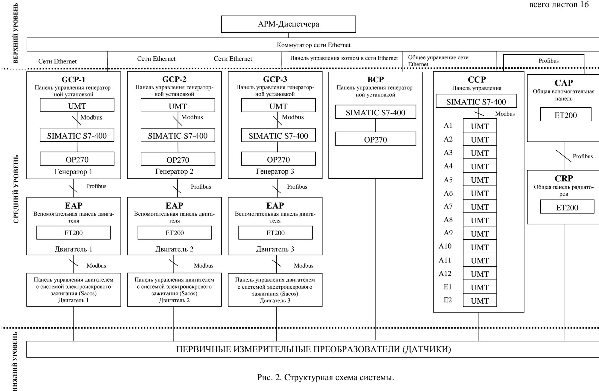
Рис. 2. Структурная схема системы.
